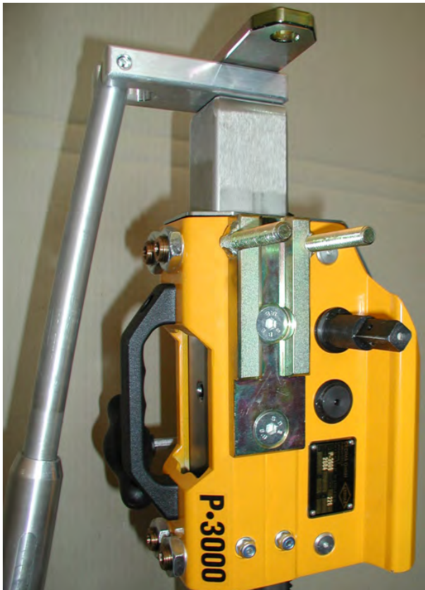
(Obere und seitliche) Hydraulikzylinder-Halteplatte am P-3000-Führungsschlitten montiert
