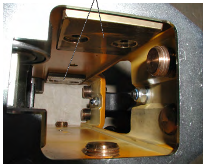
Führungsschlitten demontiert (Blick von oben)
