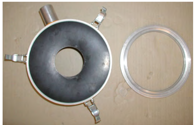
Dichtscheibe (für Ø 81 mm Bohrkronen) in Wassersammelring eingelegt
