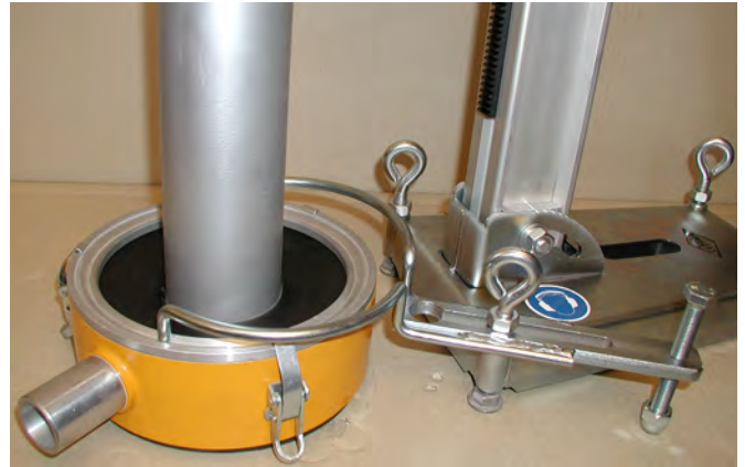
Wassersammelring mit Wassersammelring-Halter an Bohrkronen ausgerichtet, H-201 (P-3000 analog) Bild 3.60
