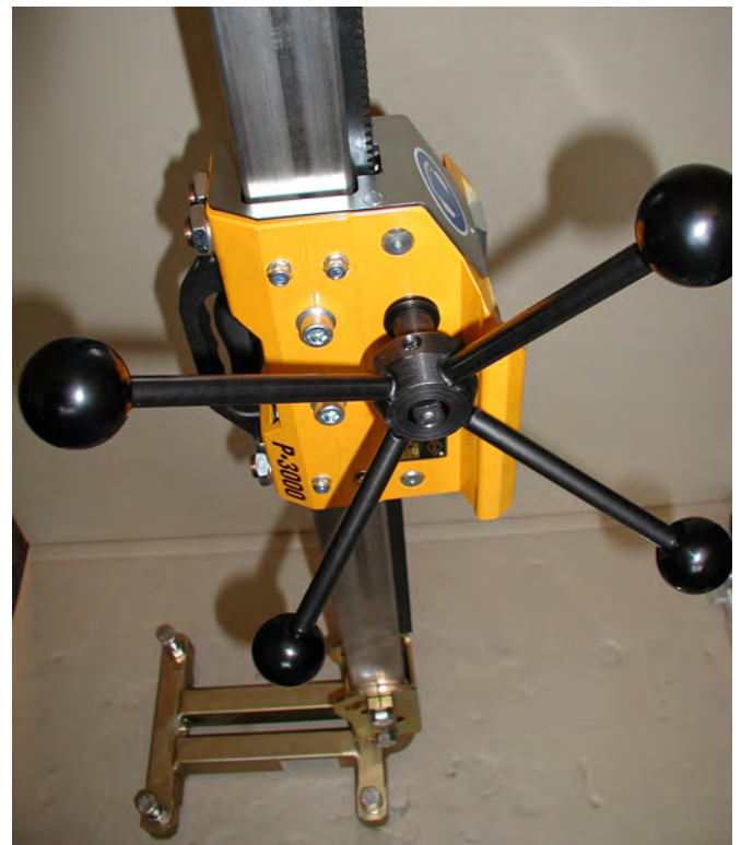
Drehkreuz an P-3000-Führungsschlitten (links) montiert
