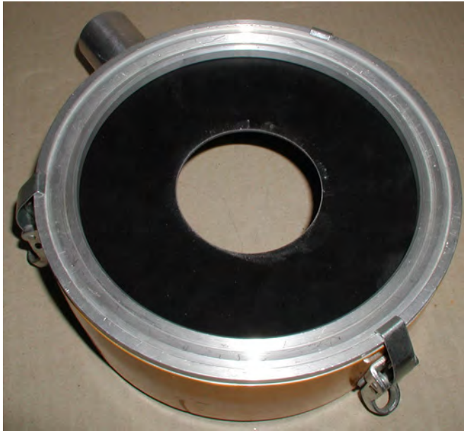
Wassersammelring mit eingeleger Dichtscheibe (für Ø 81 mm Bohrkronen) und aufgespanntem Deckel (-Ring) Bild 3.54
