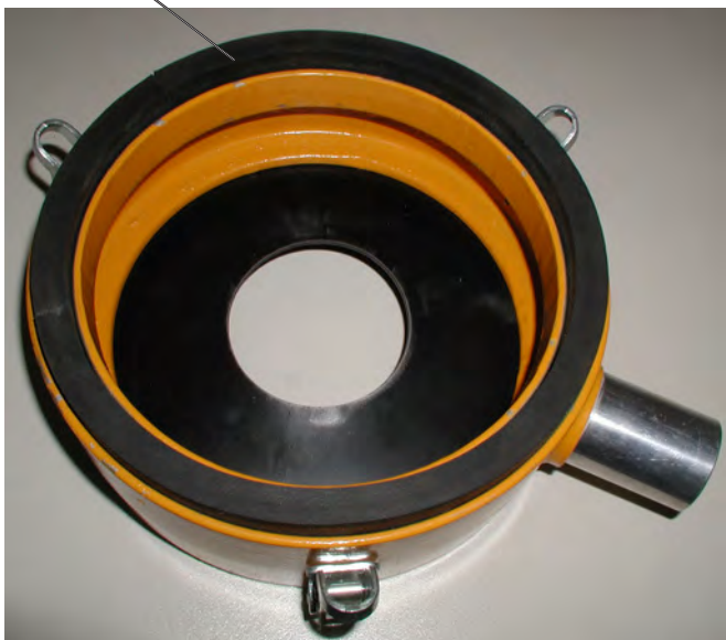
Wassersammelring (Unterseite, Dichtseite zum Untergrund/Wand) mit eingelegetem Dichtgummi Bild 3.55
