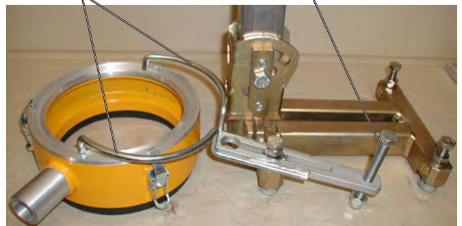
Wassersammelring mit Halter am P-3000-Profi-Dübelfuß Bild 3.56
