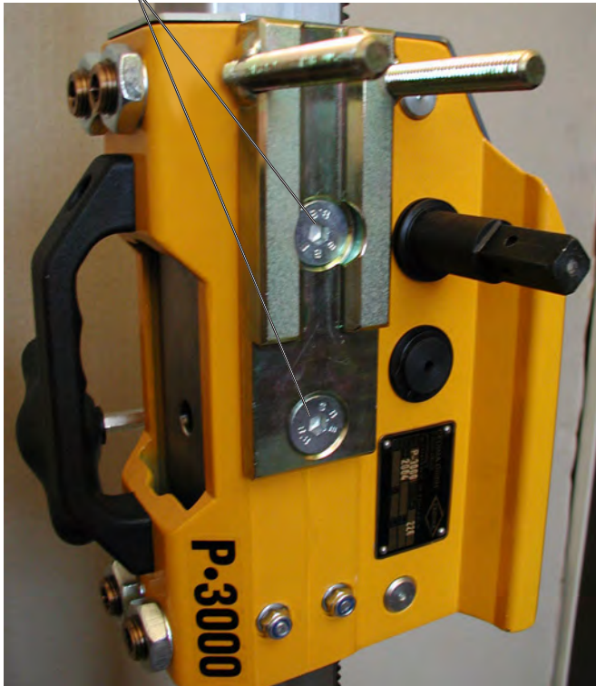
(Seitliche) Hydraulikzylinder-Halteplatte am P-3000-Führungsschlitten montiert
