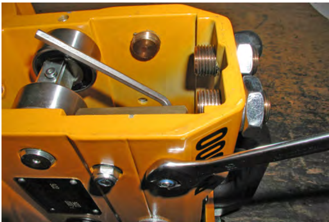
Führungsschlitten (Blick auf die Unterseite), demontieren der unteren Messingplatte Bild 7.10
