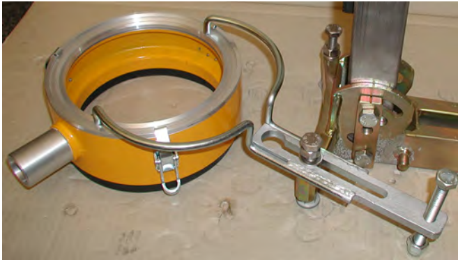
Wassersammelring mit Halter am P-3000-Uni-Dübelfuß Bild 3.57
