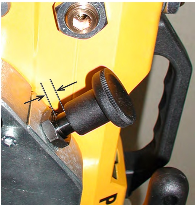
Führungsschlitten-Rastbolzen außer Funktion gesetzt (Verfahrposition)
