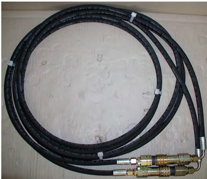
Hydraulikkupplungen der Hydraulikschläuche für Transport zusammengekuppelt
