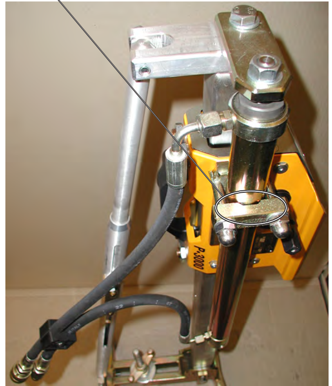
Bohr-Vorschub-Hydraulikzylinder VZ-1 (mit Klemmlasche) an seitlicher P-3000-Halteplatte geschraubt Bild 3.70
