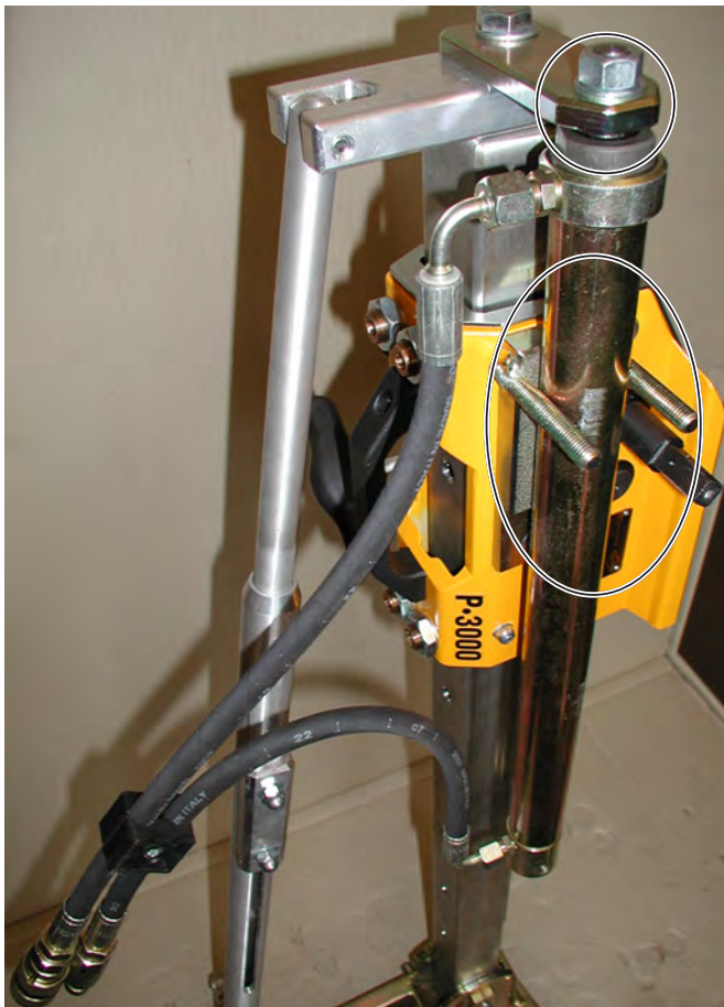
Bohr-Vorschub-Hydraulikzylinder VZ-1 in seitlicher P-3000-Halteplatte eingelegt und an oberer P-3000-Halteplatte geschraubt Bild 3.69
