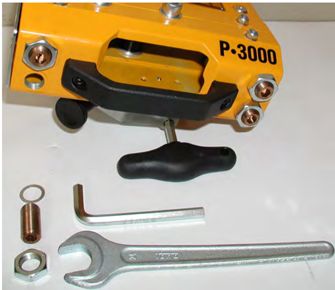
Einstellbare Gleitführung (Messingbuchse mit Passscheibe und Sicherungsmutter) vom P-3000-Führungsschlitten demontiert (Gabelschlüssel SW 24 und Innensechskantschlüssel SW 8) Bild 7.4
