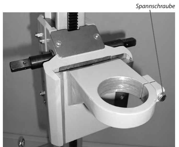
Bohrmotor-Anbauplatte für Spannhals-Bohrmotore (Typ B) am H-201-Führungsschlitten montiert (Position 1, analog zu P-3000) Bild 3.38
