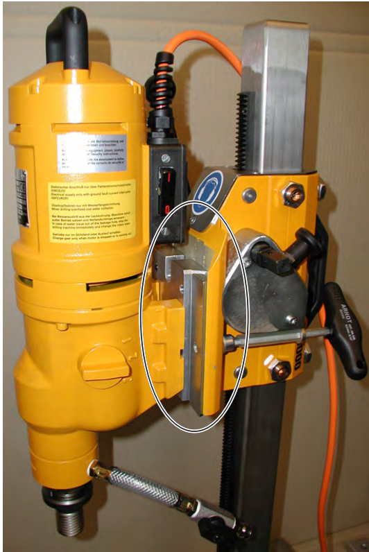
Bohrmotor DK-32 EL mit Bohrmotor-Anbauplatte Typ C am P-3000-Führungsschlitten montiert (Pos. 2)
