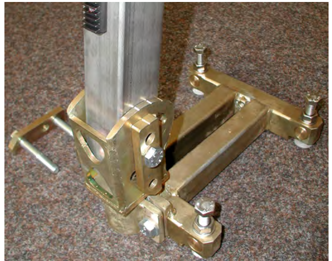
P-3000 Profi-Dübelfuß, Schrauben der Bohrsäule mit Klemmlasche und (mittlerer) Schraube montiert Bild 3.4
