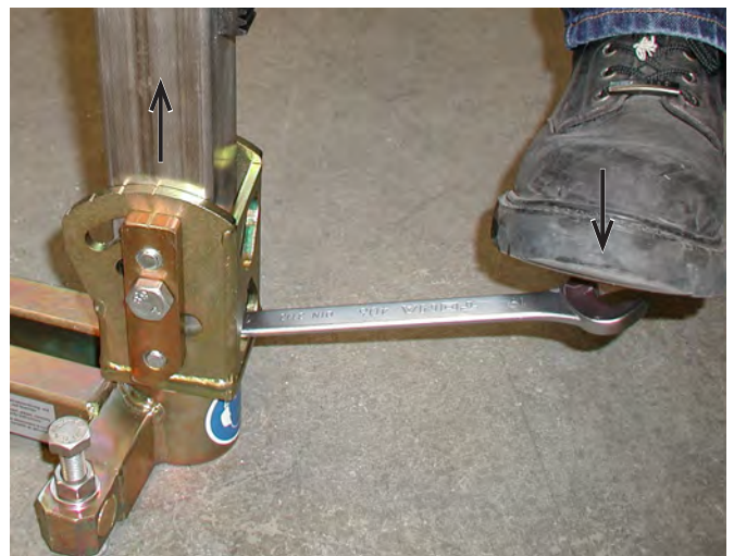
Ausheben der Bohrsäule am P-3000-Profi-Dübelfuß
