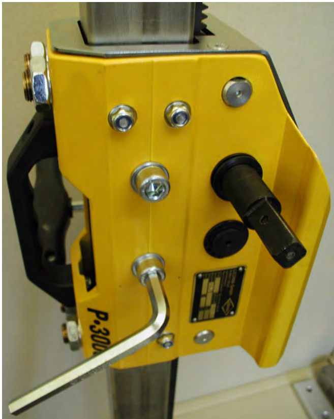
(Gewinde-) Schutzschrauben (Unterlegscheiben) vom P-3000- Führungsschlitten entfernen Bild 3.63
