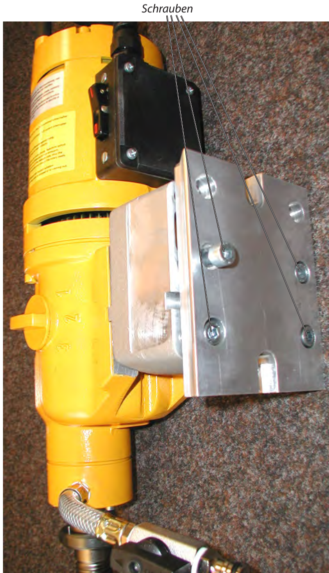
Bohrmotor DK-32 EL mit Distanzplatte 60 mm und Bohrmotor-Anbauplatte Typ C montiert (Pos. 2) Bild 3.49
