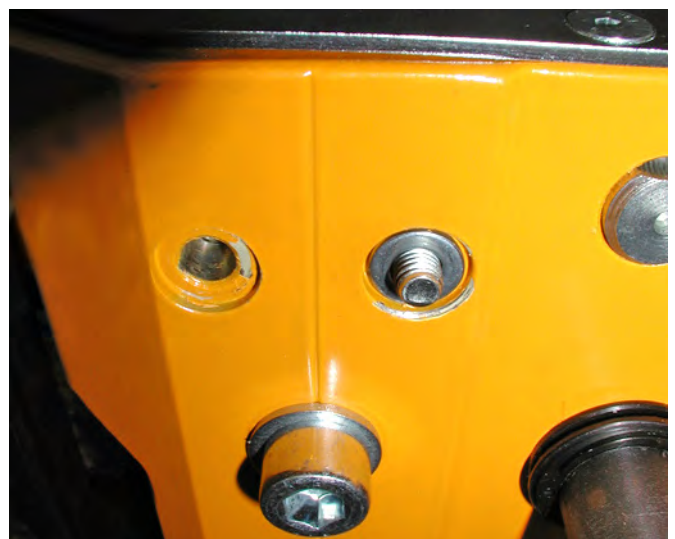
Führungsschlitten, Unterlegscheibe auf einer Befestigungsschraube der oberen Messingplatte Bild 7.12
