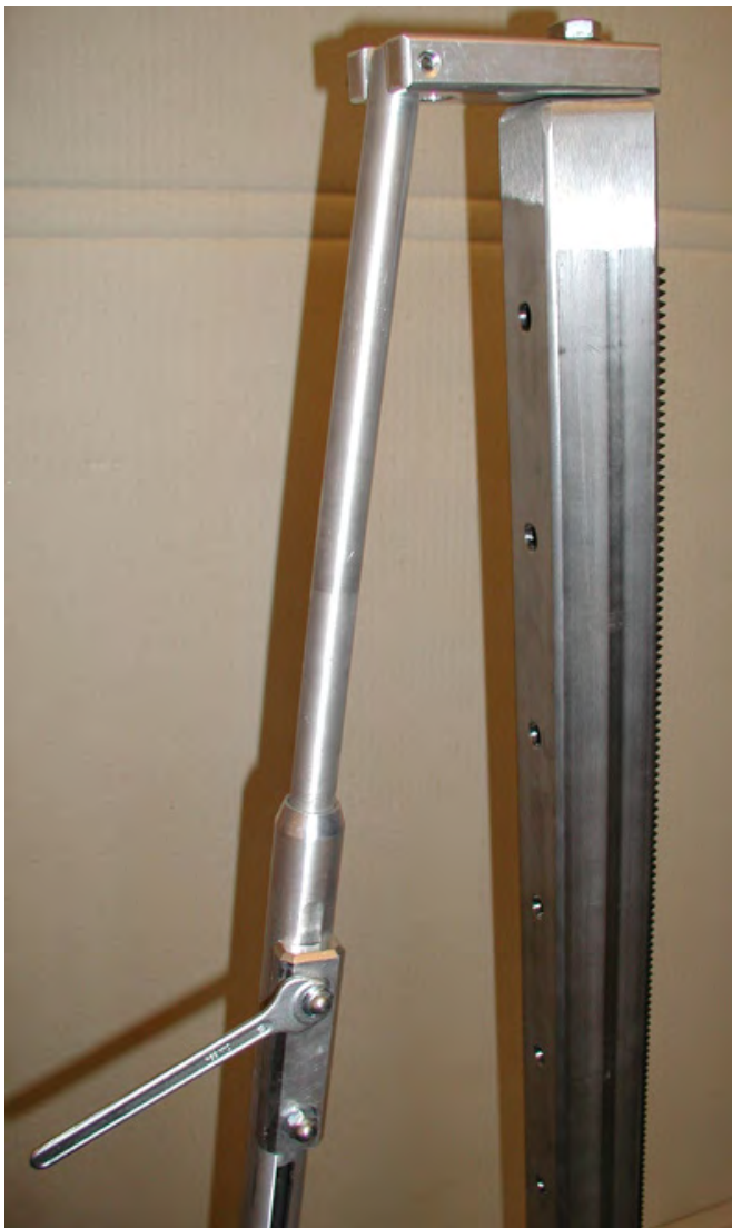
Teleskop-Bohrsäulen-Stütze bis zur Bohrsäulen-Spitze ausgezogen (obere Anbauplate montiert) Bild 3.14
