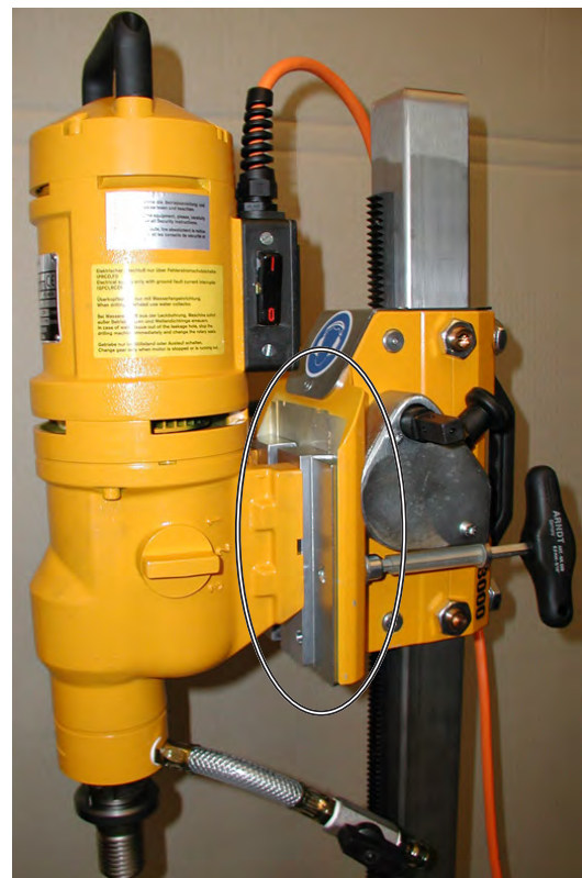
Bohrmotor DK-32 EL mit Bohrmotor-Anbauplatte Typ C am P-3000-Führungsschlitten montiert (Pos. 1 für großen Hub)
