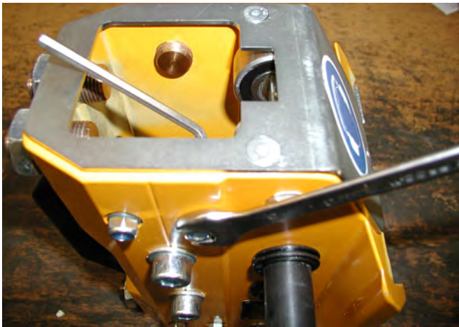
P-3000-Führungsschlitten (Blick von oben), demontieren der oberen Messingplatte Bild 7.9
