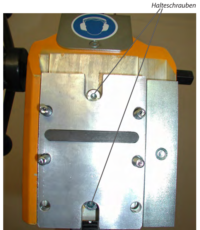
Zylinderschrauben (Halteschrauben an der Bohrmotor-Anbaufläche) des P-3000-Führungsschlittens, entsprechende Aufnahmen der Bohrmotor-Anbauplatten (zur Anschauung Anbauplatte Typ C, ohne Bohrmotor, montiert) Bild 3.37
