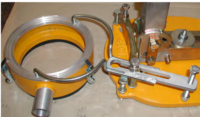
Wassersammelring mit Halter am P-3000-Uni-Dübelfuß auf der Vakuumplatte VP-150 montiert Bild 3.58
