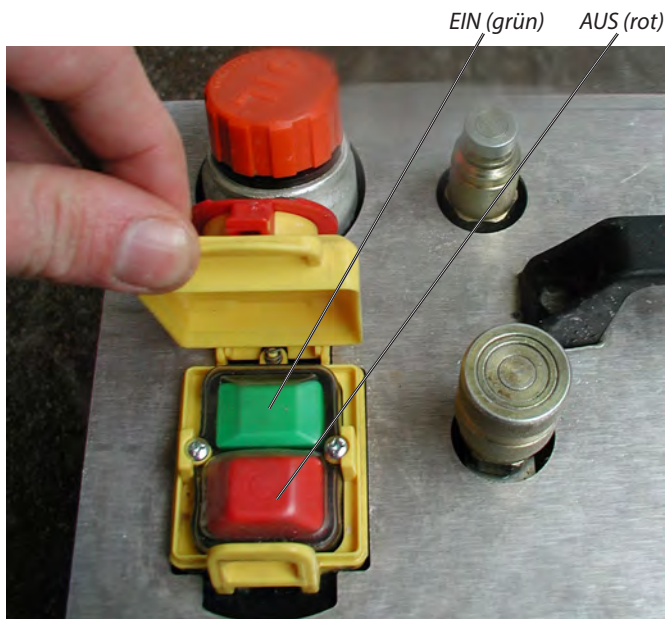
EIN-/AUS- Schalter am optionalen Hydraulikaggregat HAG-2 (Not-AUS aufgeklappt) Bild 4.3
