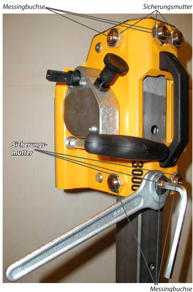
Einstellbare Gleitführungen (Messingbuchsen) am P-3000-Führungsschlitten (Gabelschlüssel SW 24 und Innensechskantschlüssel SW 8 angesetzt) Bild 7.1
