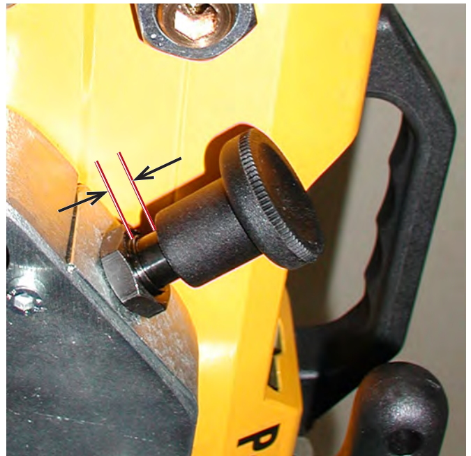
P-3000-Führungsschlitten-Rastbolzen außer Funktion gesetzt (Verfahrposition)
