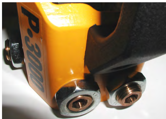
Einstellbare Gleitführungen (Messingbuchsen) am P-3000-Führungsschlitten, links Verschleißgrenze erreicht (Bündig mit Sicherungsmutter) Bild 7.2
