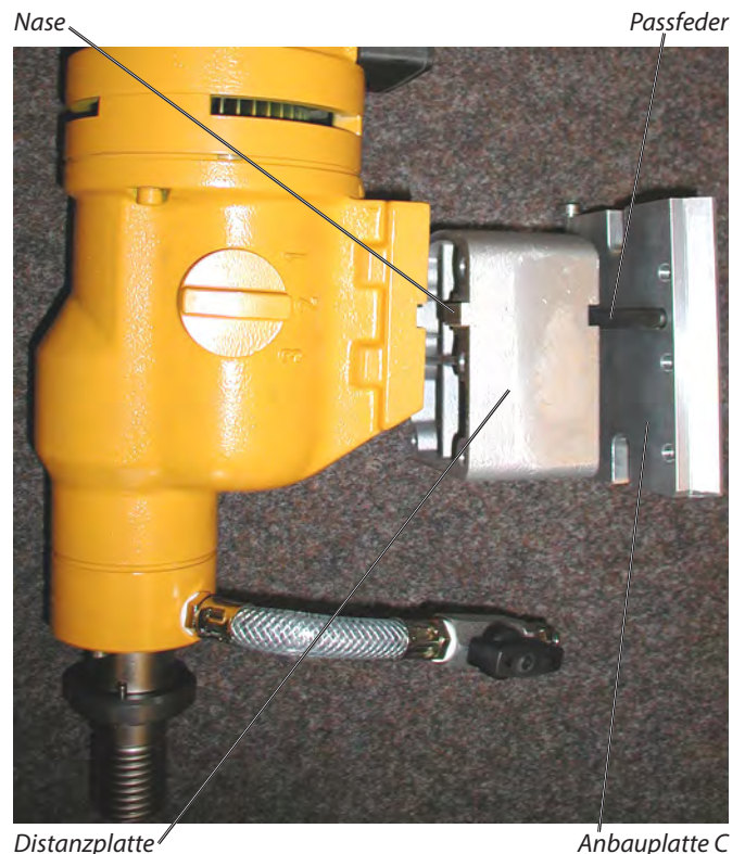
Bohrmotor DK-32 EL mit Distanzplatte 60 mm und Bohrmotor-Anbauplatte Typ C (Pos. 1) für großen Hub zurechtgelegt
