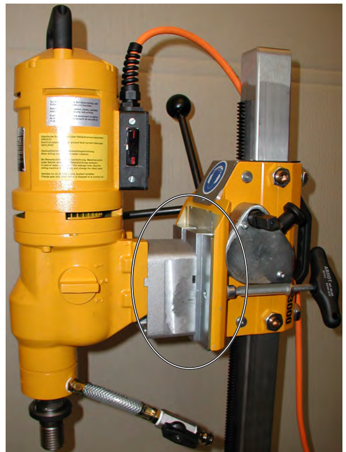
Bohrmotor DK-32 EL mit Distanzplatte 60 mm und Bohrmotor-Anbauplatte Typ C am P-3000-Führungsschlitten montiert (Pos. 1 für großen Hub) Bild 3.50
