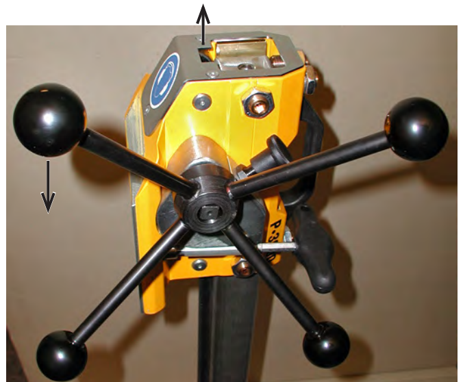
P-3000-Führungsschlitten über die Bohrsäulen-Zahnstange hinaus fahren Bild 7.5
