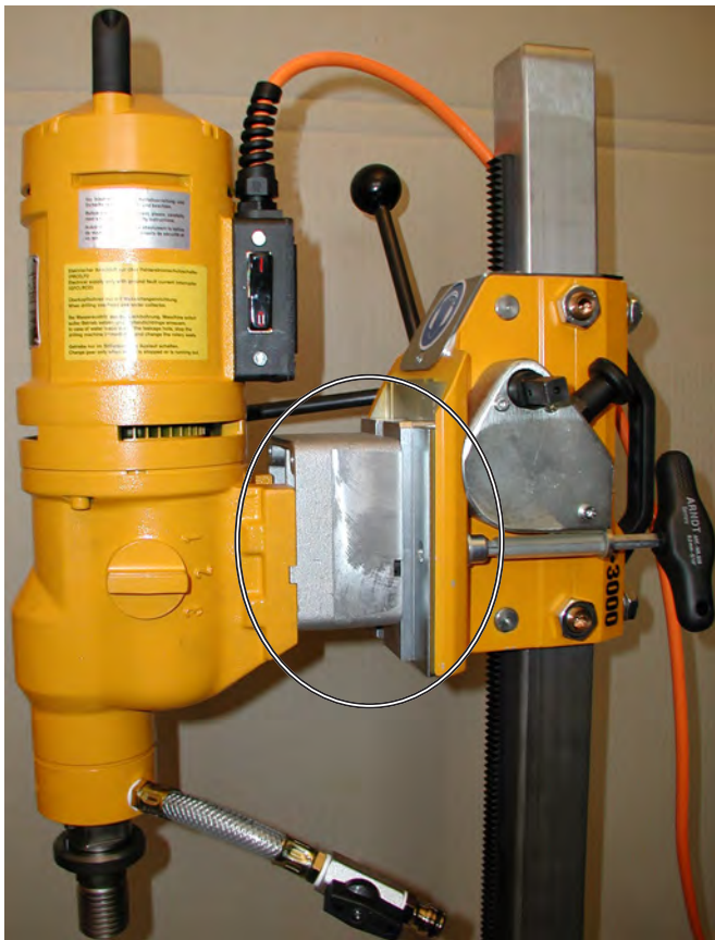
Bohrmotor DK-32 EL mit Distanzplatte 60 mm und Bohrmotor-Anbauplatte Typ C P-3000-Führungsschlitten montiert (Pos. 2) Bild 3.51
