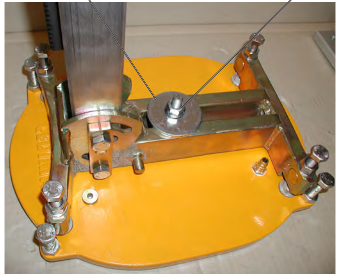
Uni-Dübelfuß (mit Unterlegscheibe vom optionalen Verankerungsdübel) auf der Vakuum-Platte VP-150 montiert Bild 3.30
