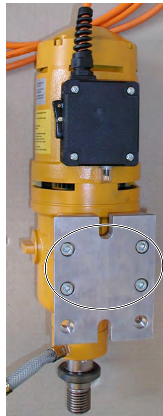
Bohrmotor DK-32 EL, mit montierter Bohrmotor-Anbauplatte Typ C (Pos. 1) für großen Hub Bild 3.43
