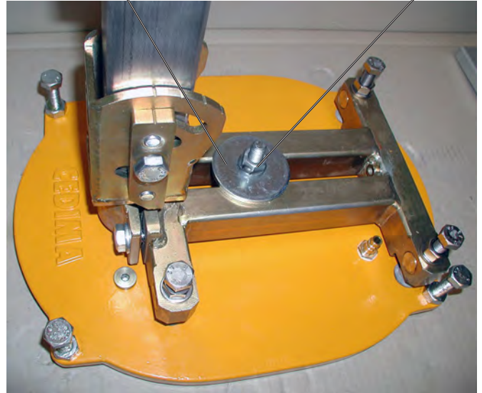
Profi-Dübelfuß (mit Unterlegscheibe vom optionalen Verankerungsdübel) auf der Vakuum-Platte VP-150 montiert Bild 3.29
