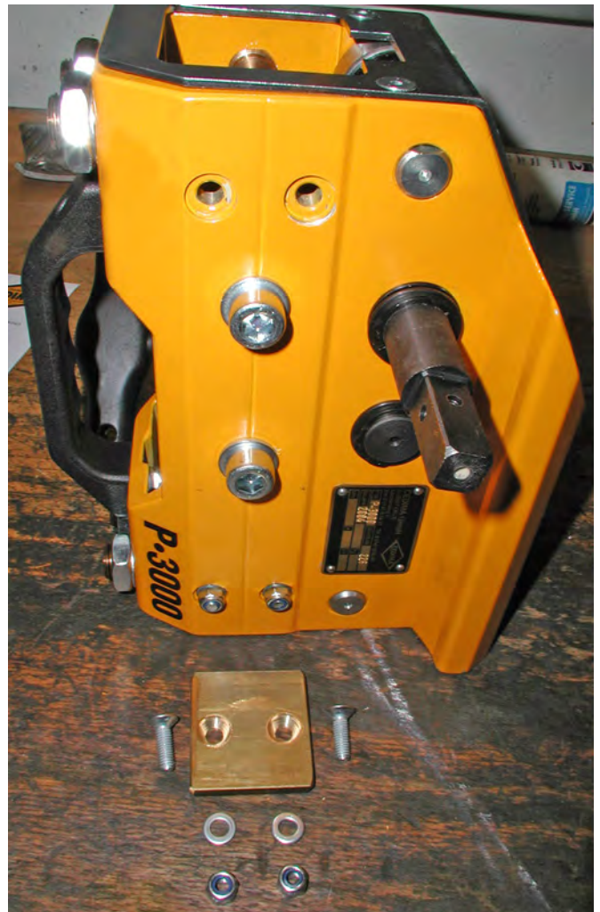
Führungsschlitten, obere Messingplatte (mit Schrauben, Unterlegscheiben und Muttern) fertig zum Montieren Bild 7.11
